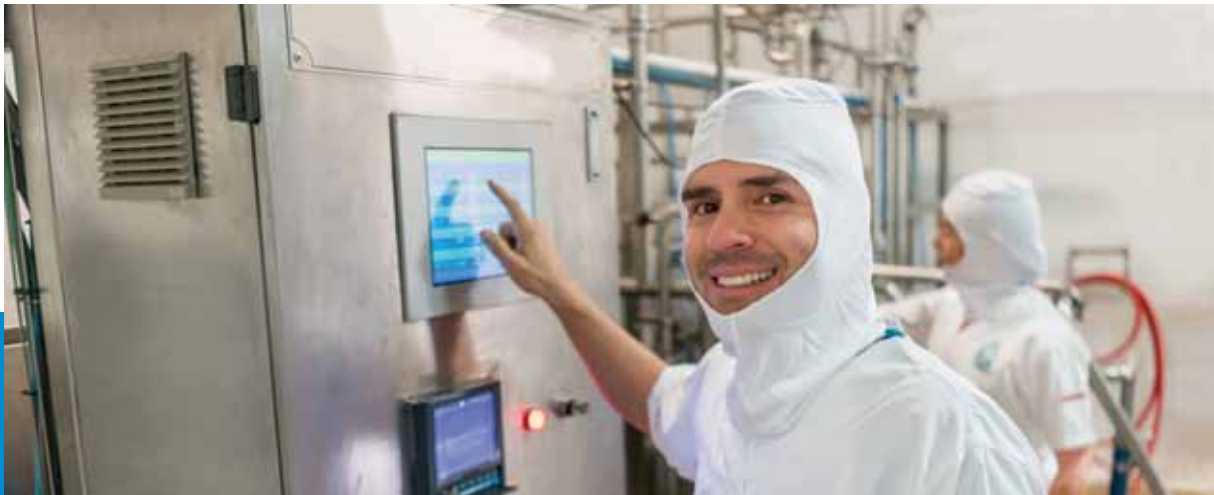
Lebensmittelechtes Gehäuse aus Edelstahl mit Steuerung
