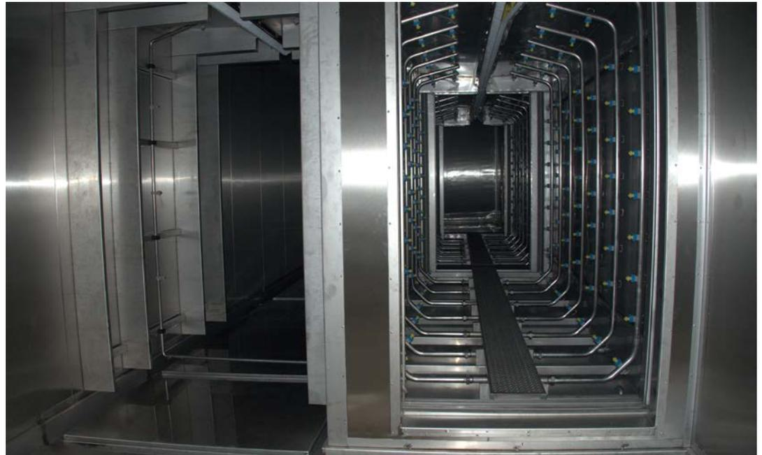
Mitten in der Vorbehandlung trennen sich die Werkstücke. Stahlteile durchfahren einen Bypass-Tunnel, Aluminium- und Zinkbauteile werden deoxidiert.
