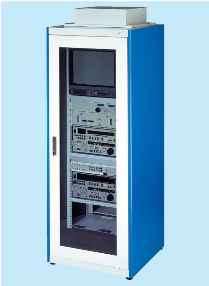
Ein patentiertes **Schalldämpfungssystem** kann den, in dem Schrank durch die eingebauten Komponenten, entstehenden Lärm in der Spitze um 41 dB vom ursprünglichen Lärmpegel dämpfen. Ausgewertet nach DIN 45631 (Zwicker-Verfahren) entspricht die Lärmdämpfung einer Verringerung der empfundenen Lautheit auf den 30. Teil gegenüber einem herkömmlichen offenen Gestell.
